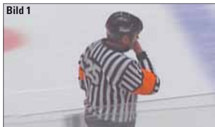
Bild 1 Bei Bewegungen zwischen zwei Halbbildern weisen Objektkonturen Treppchenstufen (Jaggies) auf
