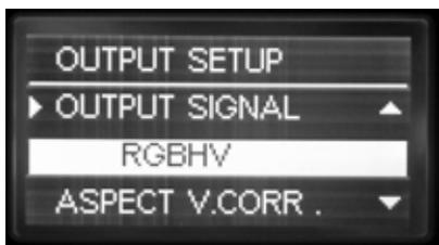
(4) Der aktuell eingestellte Wert („RGB HV“) ist jetzt blau hinterlegt, wählen Sie mit den [+] / [-] Tasten den gewünschten Wert (z.B. „YUV“) aus und aktivieren Sie diesen mit [enter].
