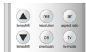
Ebenso wie der „TV-Mode“ kann der gewünschte „Overscan“ auch für jeden Eingang vordefiniert werden, d.h. im Input Setup wird hinterlegt, ob bei diesem Eingang der „Overscan“ auf „OFF“, auf ON V=H oder auf ON V/H stehen soll und um wie viel in das Bild „hineingezoomt“ bzw. vom Rand weg geschnitten werden soll. Mehr dazu unter „Input Presettings“ ab Seite 33.
